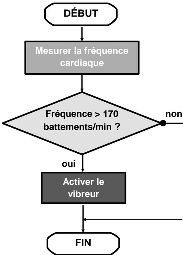
Figure 4 : algorithme traitant de l'activation du vibreur
